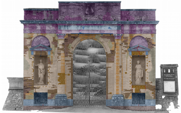
Restituzione grafica del degrado materico
